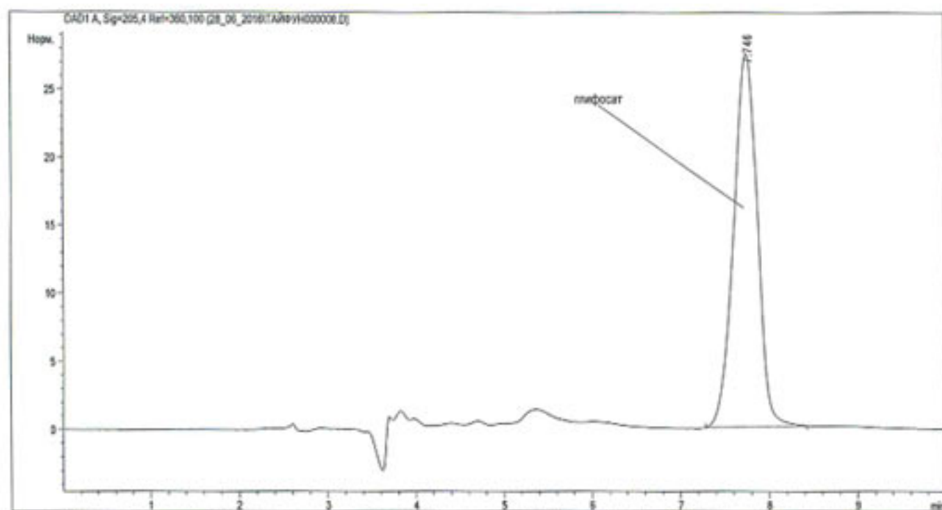
Рис. 1 Хроматограмма стандартного образца глифосата С = 0,413 мг/мл
